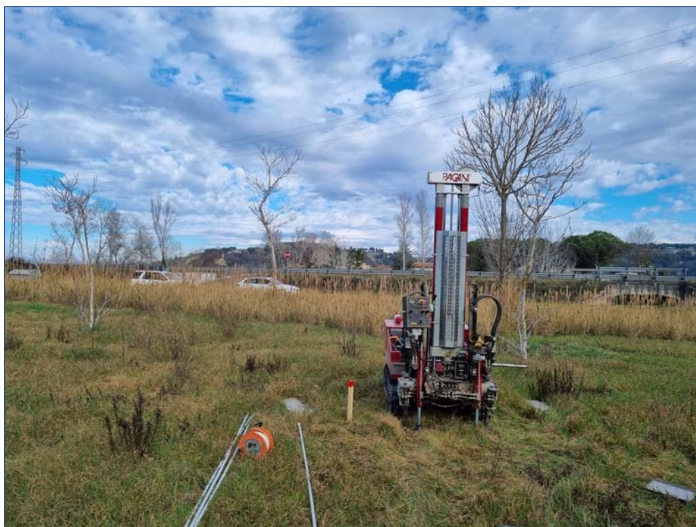
Figura 2: Postazione prova penetrometrica CPT 2
