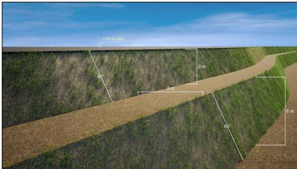
Figura 3.8/9 - Geometria delle terre armate
