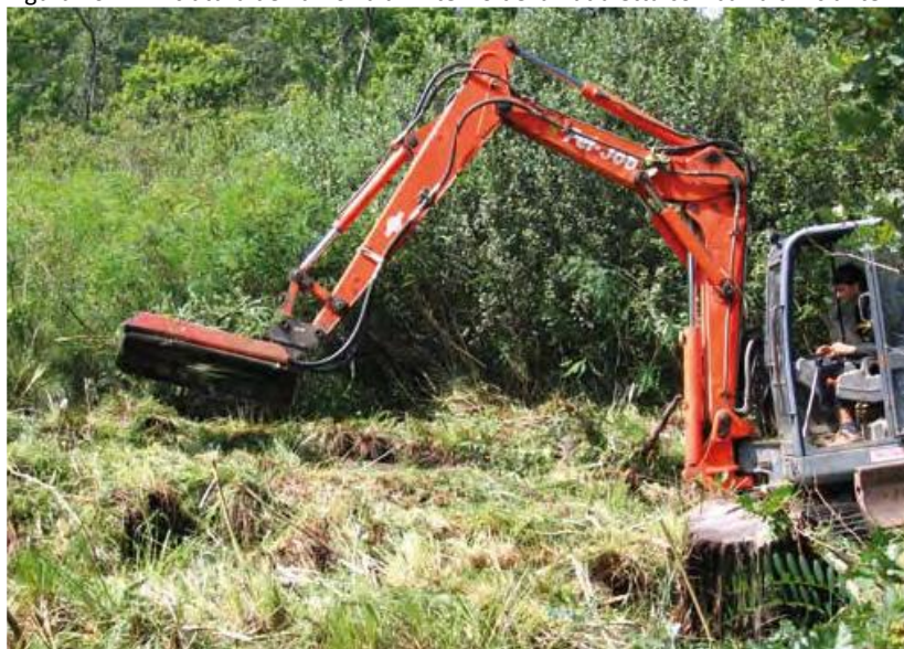
Figura 10 – Trinciatura dell'amorfa all'interno della Paduletta con barra trinciante montata su cingolato leggero
