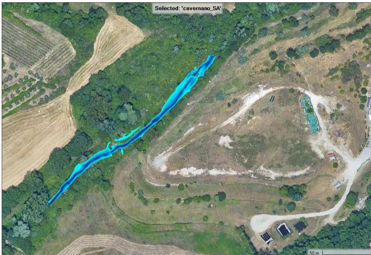
Fig. 12 – aree allagate del modello idraulico di stato attuale, con risultati della simulazione TR200-1h
