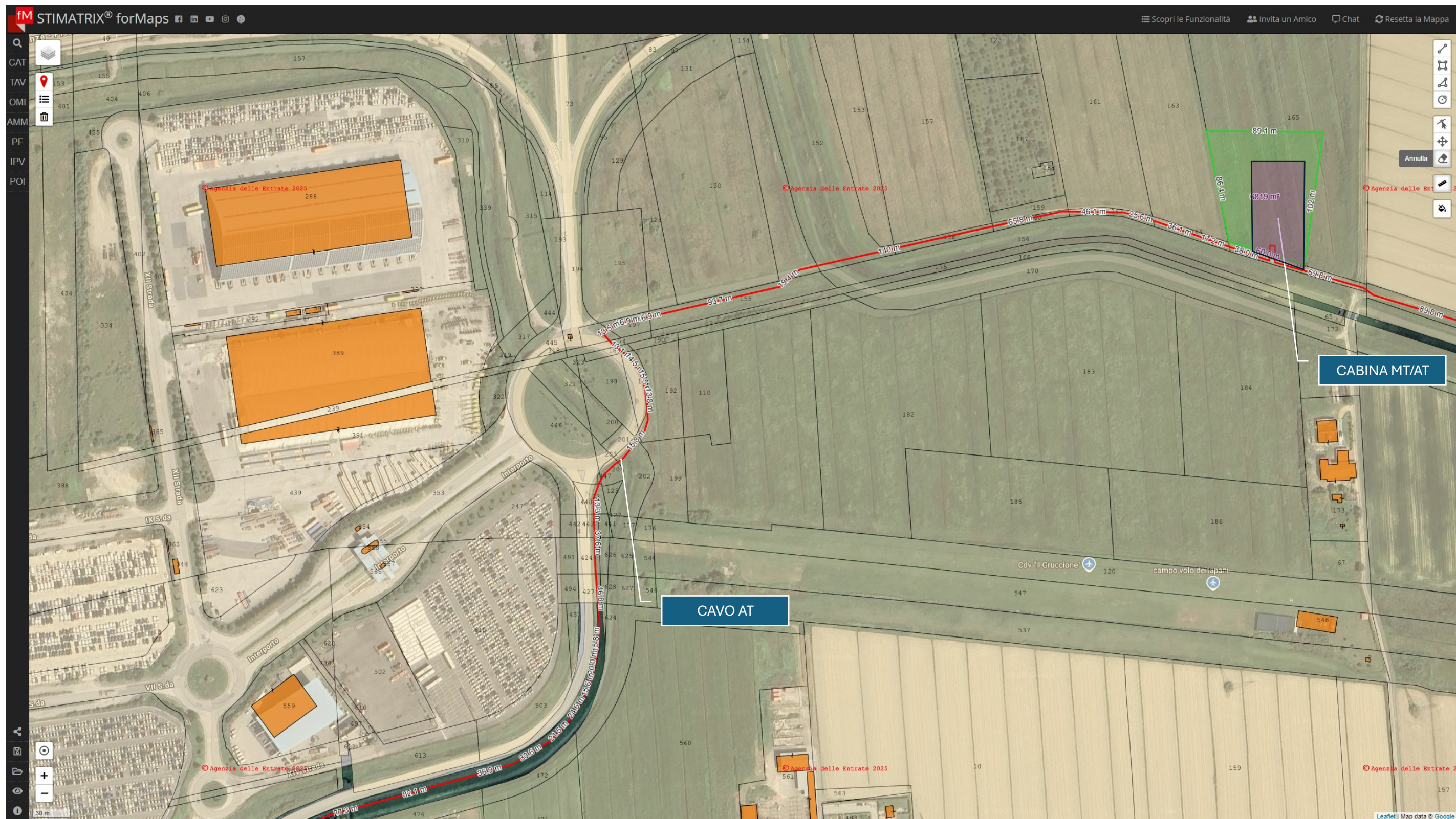
Porzione 1 del tracciato del cavidotto AT e partenza dal terreno dove è ubicata la Cabina per la trasformazione della Media Tensione in Alta Tensione (MT/AT).
