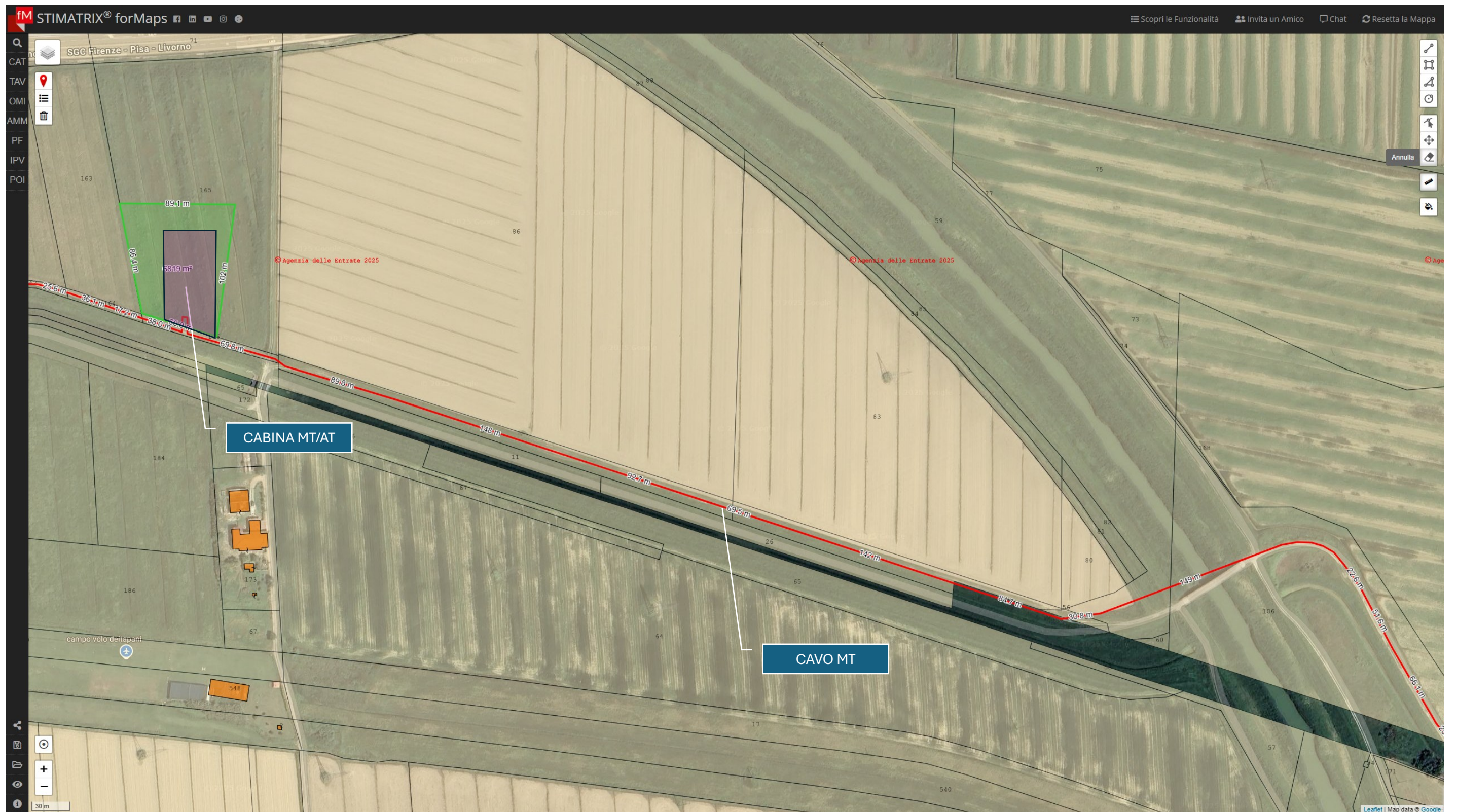
Porzione 2 del tracciato del cavidotto MT e arrivo al terreno dove è ubicata la Cabina per la trasformazione della Media Tensione in Alta Tensione (MT/AT) da cui parte il tracciato del cavidotto in AT.
