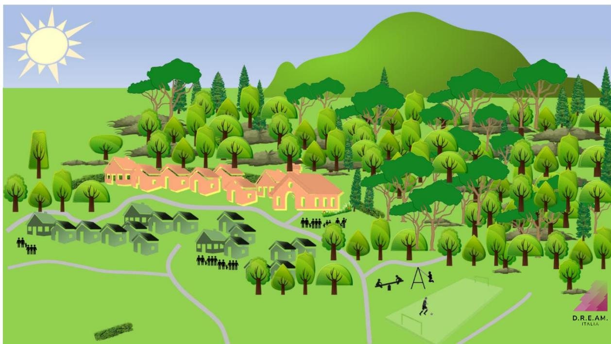
**Figura 8.23** - Disegno con evidenziate abitazioni poste in zone di interfaccia urbano-bosco in cui non è stata prevista una fascia di interfaccia (disegno D.R.E.A.M.-Italia ©).
