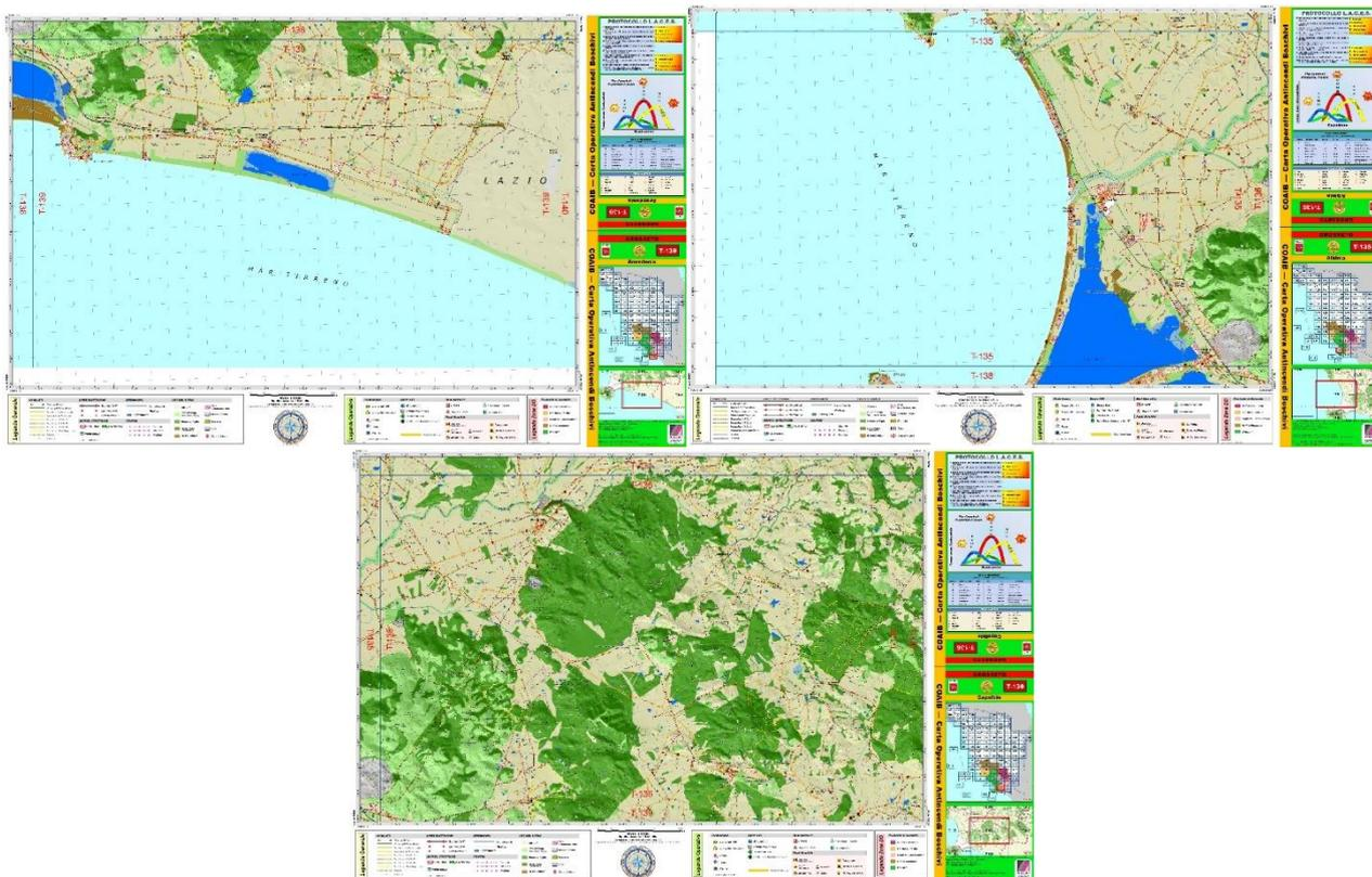
**Figura 6.4** - Cartografia operativa AIB T-135 zona Albinia, T-136 zona Capalbio e T-139 zona di Ansedonia: è in scala 1:25.000 ed è una rappresentazione cartografica in UTM metrica con sistema di coordinate geografiche LL in formato D°M°S° DATUM WGS 84.
