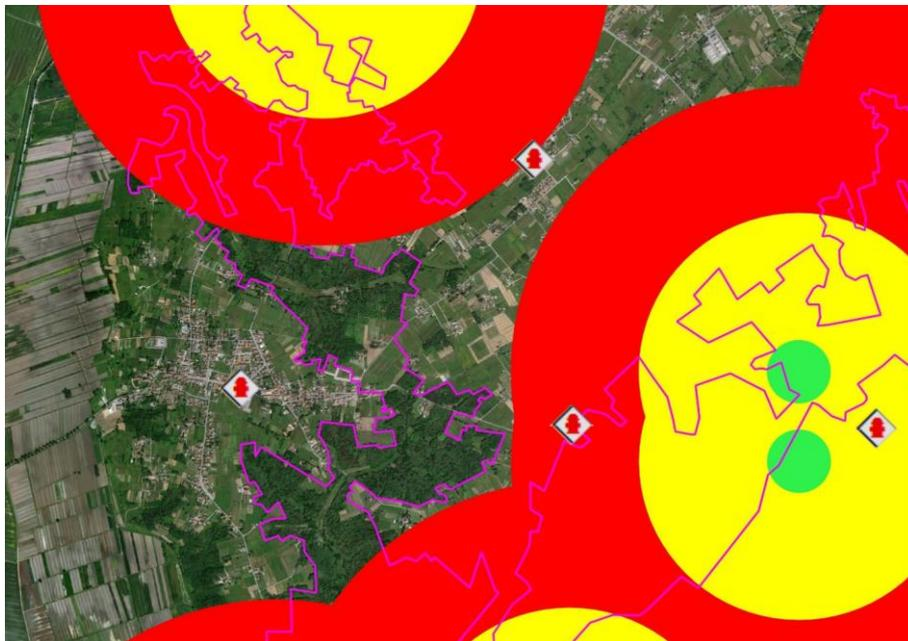
**Figura 6.19** - Posizione degli idranti in relazione ai buffer di rotazione di 3 minuti.
