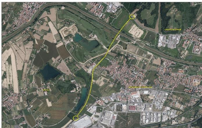
La bretella prevede la realizzazione di un nuovo ponte con struttura ad arco per lo scavalco del fiume Arno, di luce pari a 300 m e l'attestazione della nuova viabilità sulla SP 106.
