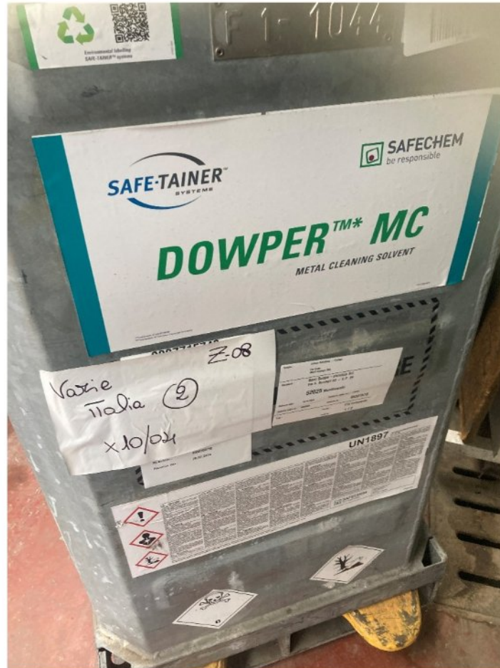
Foto 7 – Box metallico con all'interno fusto di tetracloroetilene, utilizzato per il rabbocco della macchina per lo sgrassaggio. Il box, sollevato dal transpallet, poggiava sulla griglia del POZZETTO A2.
