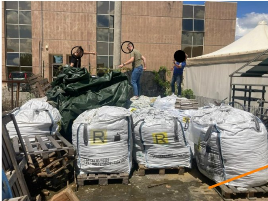
Foto 16 – Panoramica delle 17 big bags della capacità di circa 1 m3 ciascuna, contenenti il rifiuto EER 120116* e site nel resede esterno posteriore della ditta DANY, allocate su pallet su pavimentazione in calcestruzzo.
