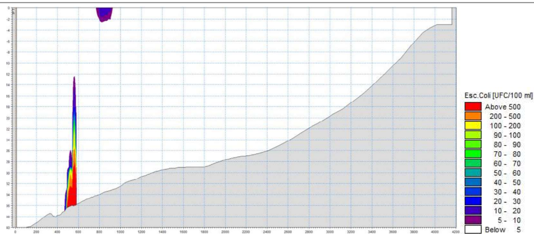
Figura 9.5 – Distribuzione verticale del plume in corrispondenza della condotta e del punto di scarico per la condizione di circolazione invernale – SCARICO ORDINARIO
