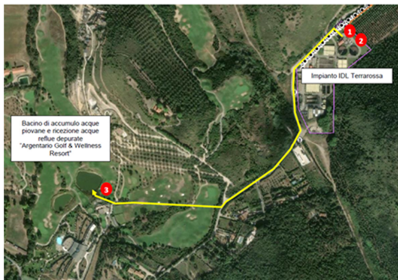
Figura 11: impianto IDL Terrarossa – riutilizzo delle acque reflue – strumentazione di monitoraggio presente: (1) – Misuratore di portata dall'acqua di riuso inviata al Golf acquisito a SCADA; (2) – Misuratore di conducibilità online presso vasca di accumulo finale acquisito a SCADA; (3) – Misuratore di conducibilità online presso bacino di accumulo dell'acqua a servizio del campo da Golf acquisito a SCADA.
