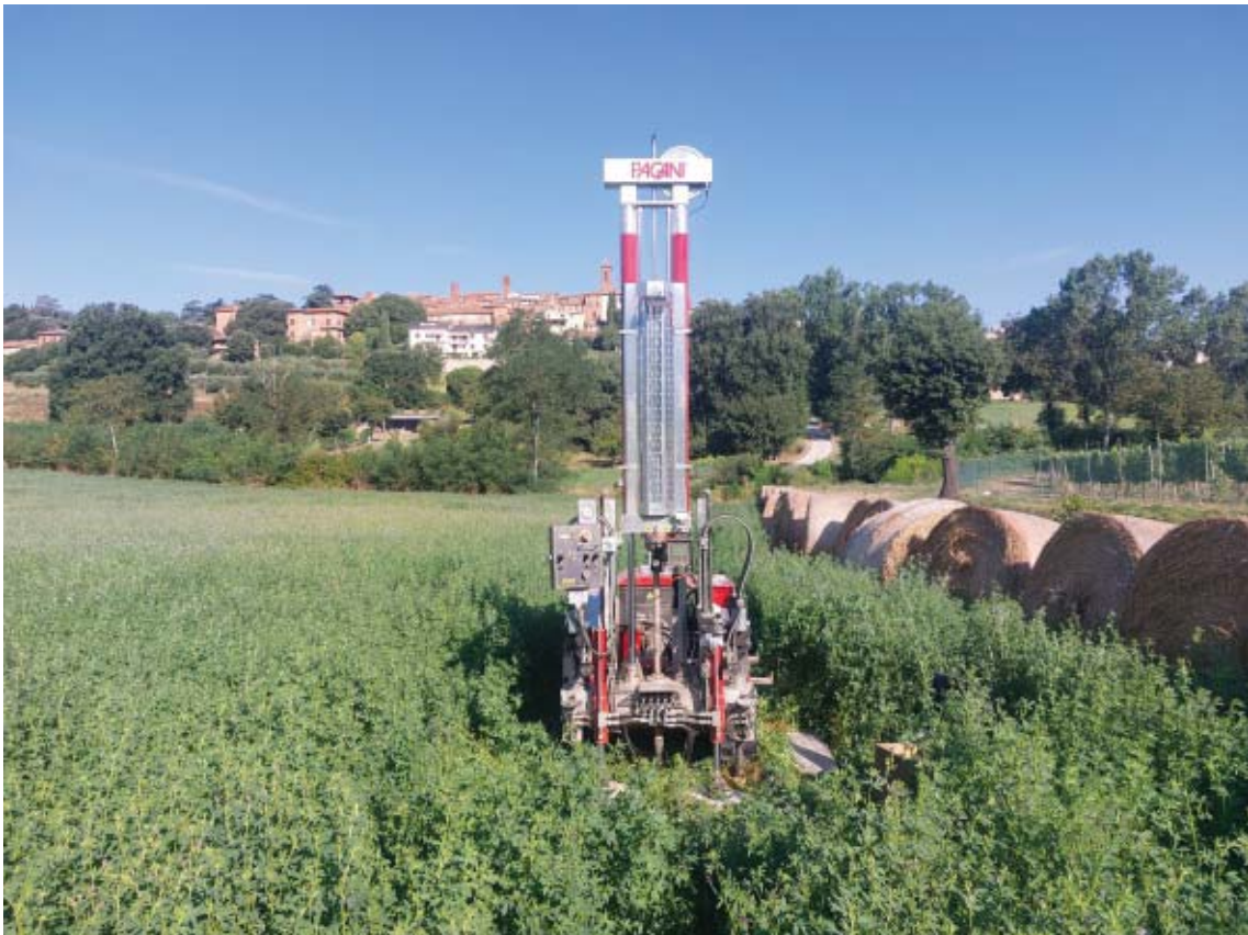
FOTO 1 : Strumentazione utilizzata per l'esecuzione della prova CPT 2.
