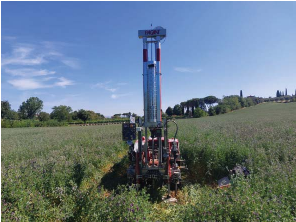
FOTO 1 : Strumentazione utilizzata per l'esecuzione della prova CPT 4.
