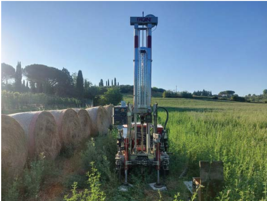
FOTO 1 : Strumentazione utilizzata per l'esecuzione della prova CPT 7.
