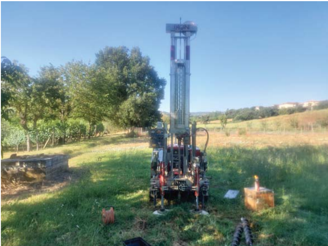
FOTO 1 : Strumentazione utilizzata per l'esecuzione della prova CPT 8.
