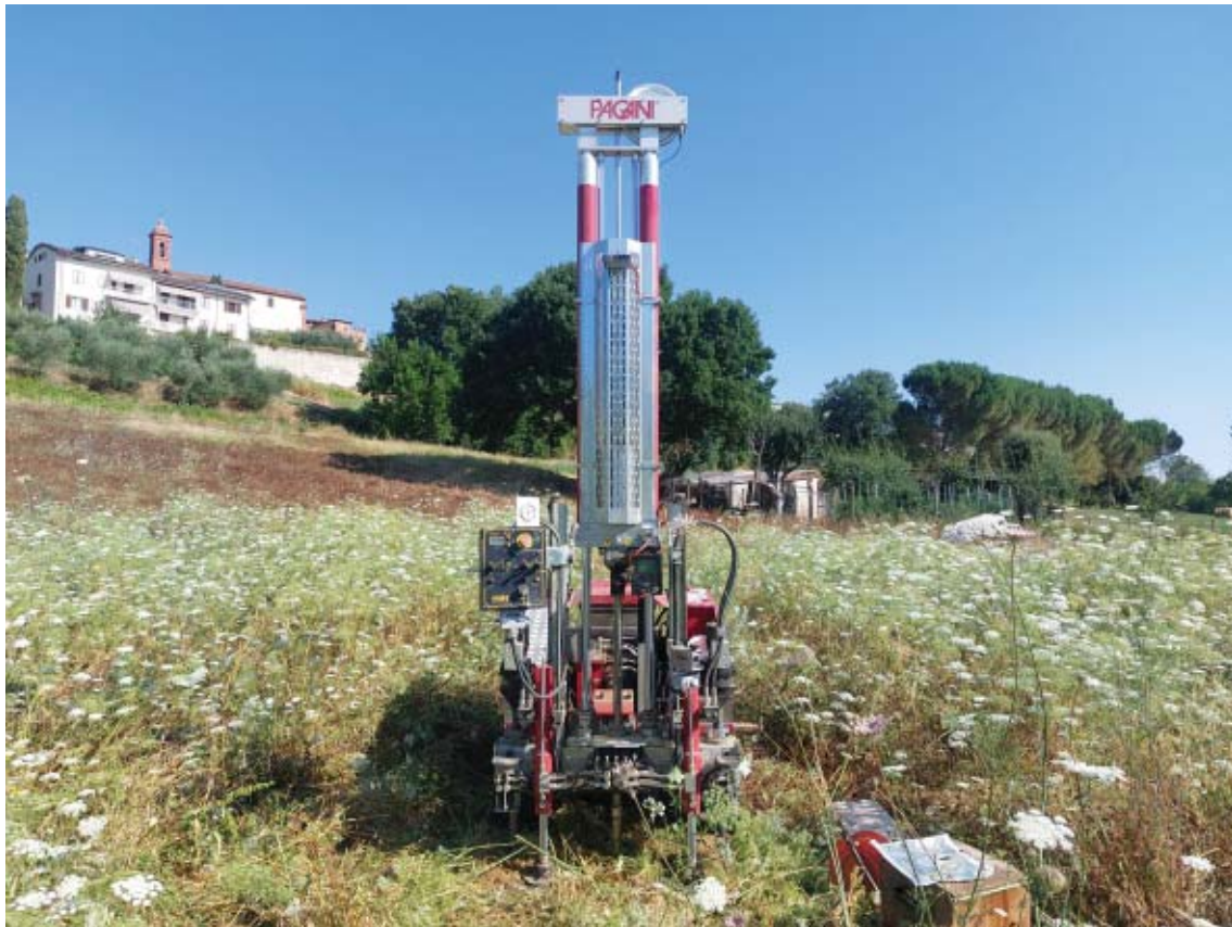
FOTO 1 : Strumentazione utilizzata per l'esecuzione della prova CPT 9.
