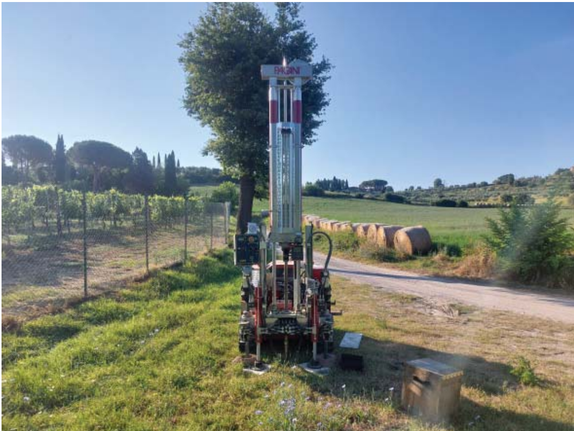
FOTO 1 : Strumentazione utilizzata per l'esecuzione della prova CPT 1.
