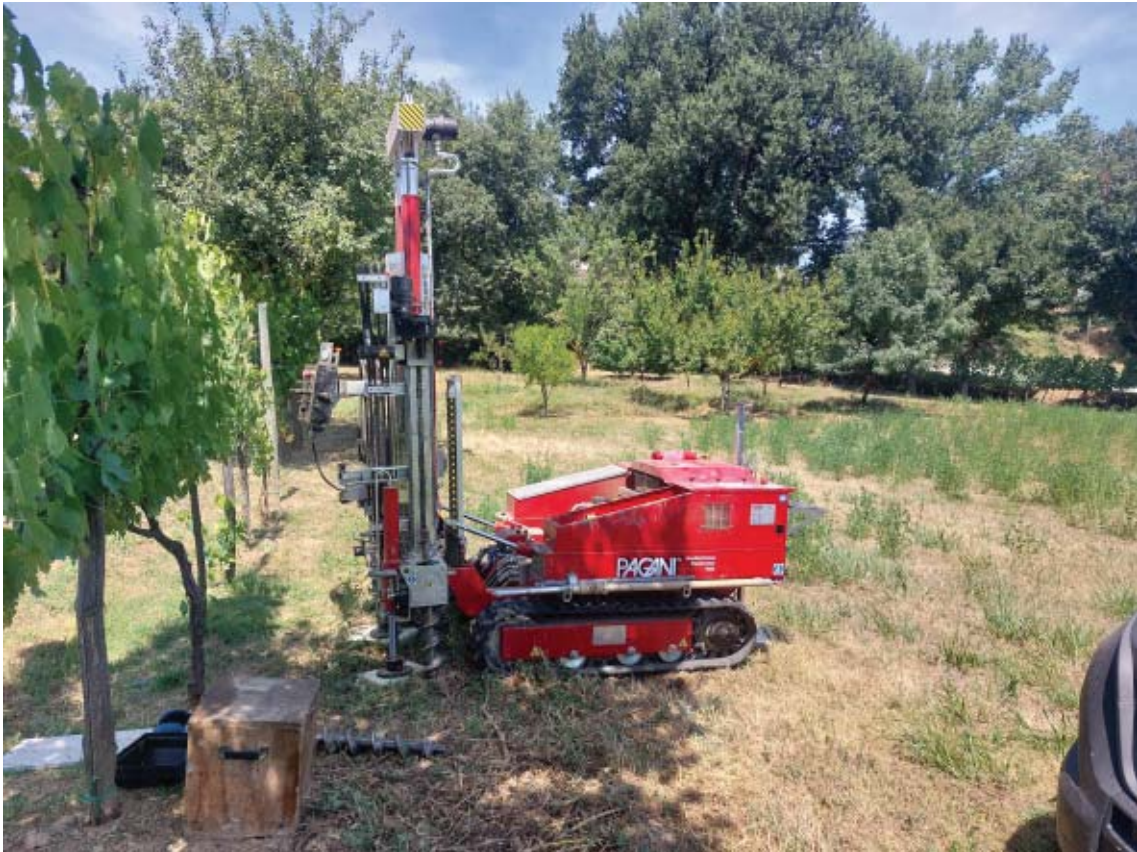
FOTO 1 : Strumentazione utilizzata per l'esecuzione della prova CPT 5.
