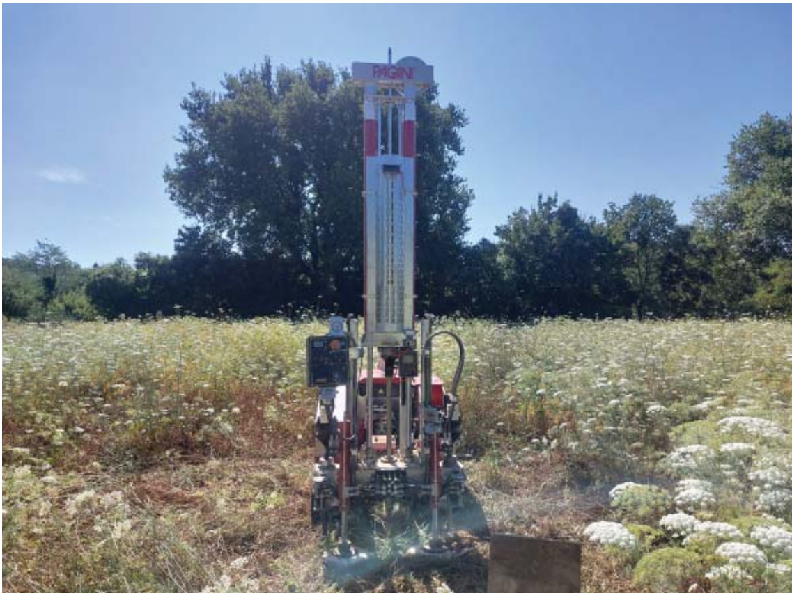
FOTO 1 : Strumentazione utilizzata per l'esecuzione della prova CPT 10.
