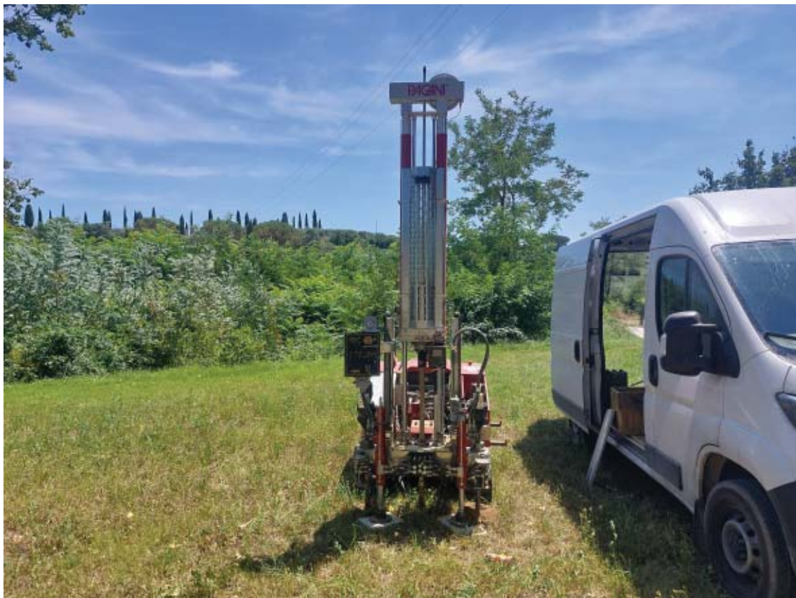
FOTO 1 : Strumentazione utilizzata per l'esecuzione della prova CPT 6.
