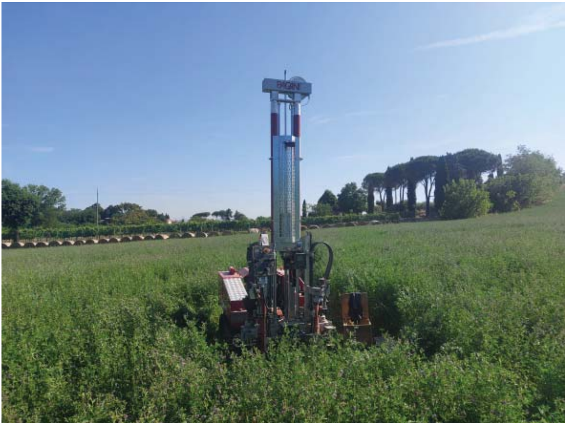
FOTO 1 : Strumentazione utilizzata per l'esecuzione della prova CPT 3.
