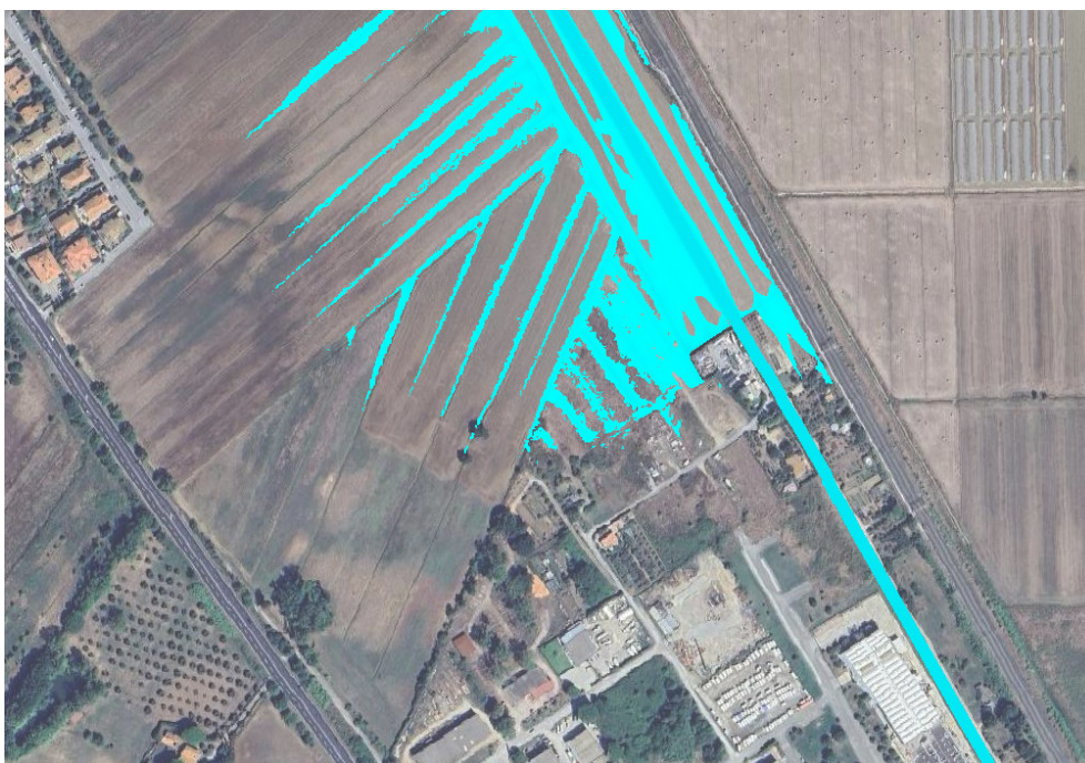
Figura 32: Alternativa di carattere idraulico n.4 - dettaglio del limite della zona industriale Mappa battenti - scenario per alluvioni rare (TR 500) - 6 ore: rivestimento in CLS della sezione di tipo trapezio a monte dell'attraversamento S.S. 1 Aurelia, adeguamento idraulico del tombino Aurelia ed allargamento della sezione idraulica a valle dello stesso senza alcun rivestimento
