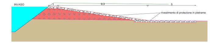
Il rivestimento del fondo dell'alveo sarà posizionato in scavo e accuratamente livellato e regolarizzato, in modo tale da non creare perturbazioni di deflusso.
