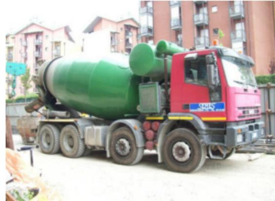
**Data rilievo:** 05.06.2009**POTENZA SONORA****L<sub>w</sub> dB(A)** 90**ANALISI SPETTRALE**
