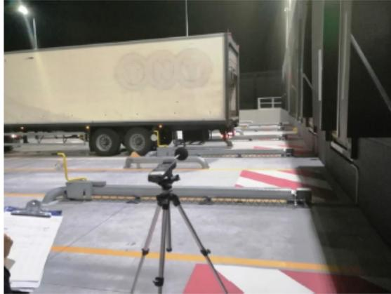
Punto di misura fonometrica a 8 m dal truck e a 1,5 m da P.C.
