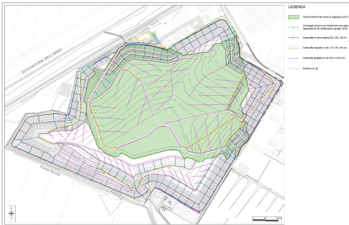
Figura 3:1 – Rete di regimazione delle acque di ruscellamento superficiale
