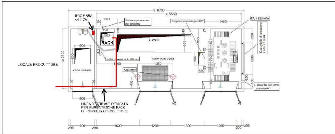
Il Produttore si collegherà alla porta n. ....1....., di seguito indicata, con cavo multimodale in fibra ottica con connettore LC/upc.
