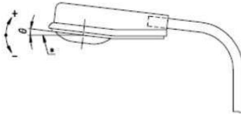
\* Traccia del piano orizzontale. Come rappresentato in figura l'angolo  $\theta$  è positivo
