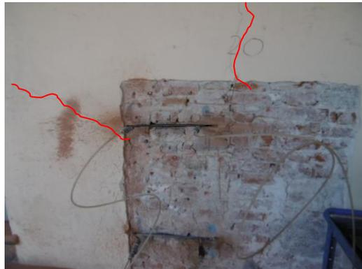
Figura 32: Rottura della muratura ai limiti del taglio, al di fuori della zona sottoposta a prova.
