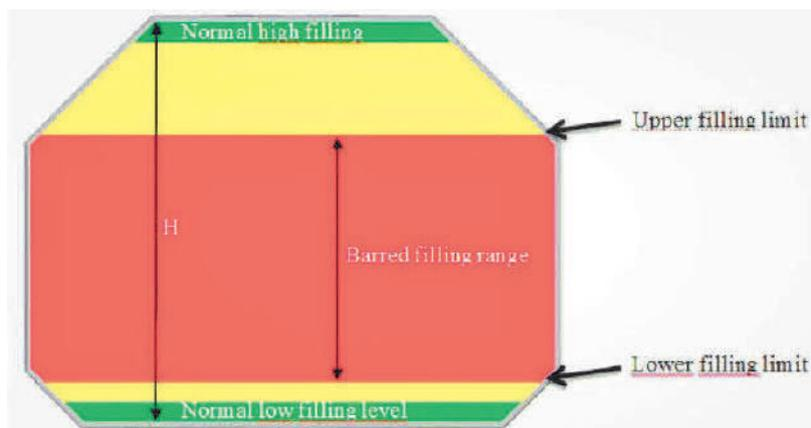
Figura 13: limiti di riempimento standard per navi LNG
