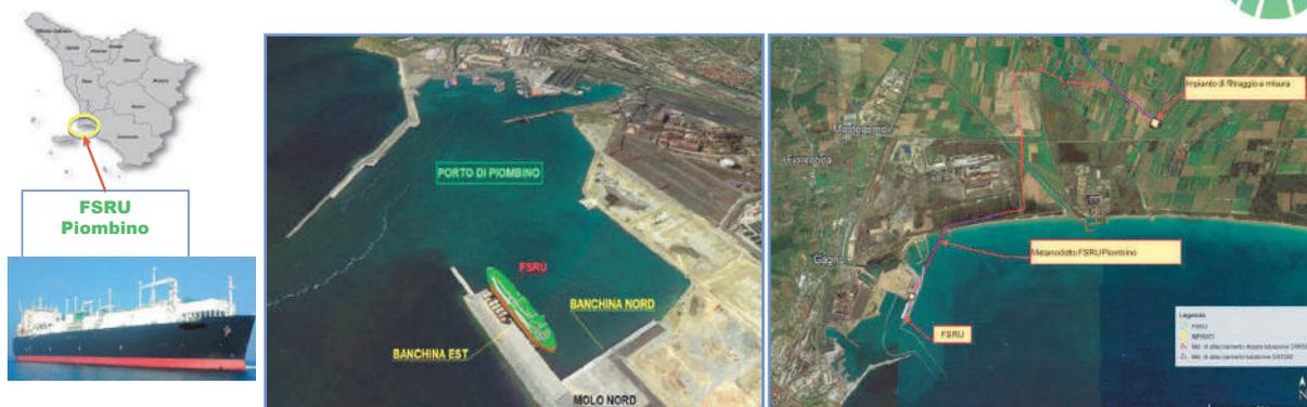
Il Progetto prevede l'ormeggio di una FSRU presso la banchina di Est della Darsena Nord del Porto di Piombino ed il trasferimento via condotta del gas naturale vaporizzato fino al punto di ingresso nella Rete Nazionale Gasdotti posto a circa 8,5 km.
