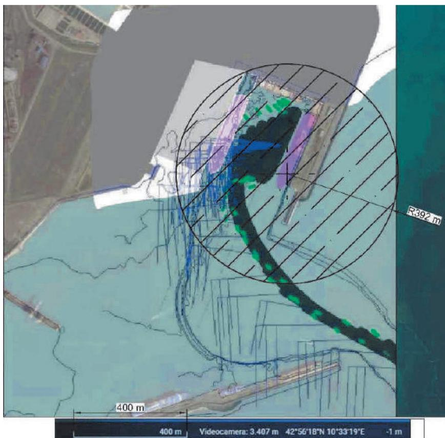
Figura 11: Area del danno di flash fire
