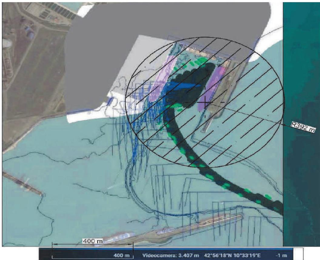
Figura 11: Area del danno di flash fire
