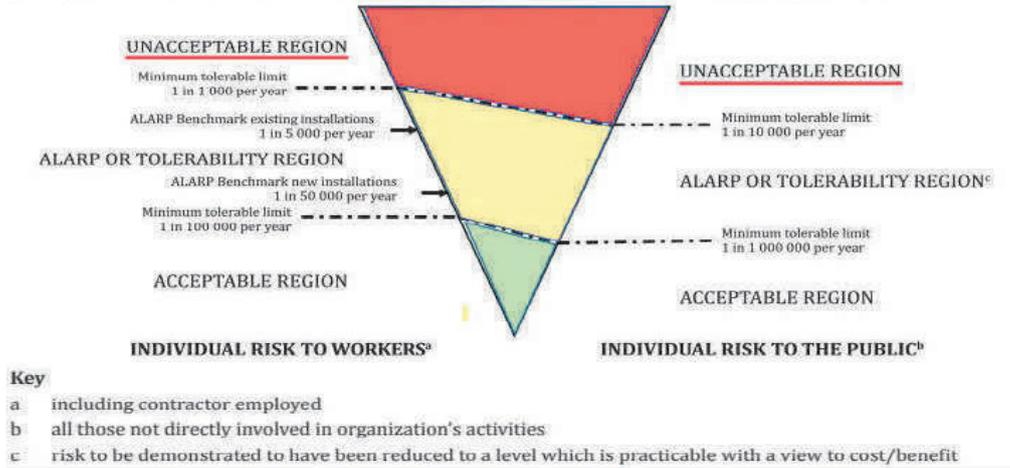
Figura 8: criteri di accettabilità del rischio da UNI EN ISO 20257
