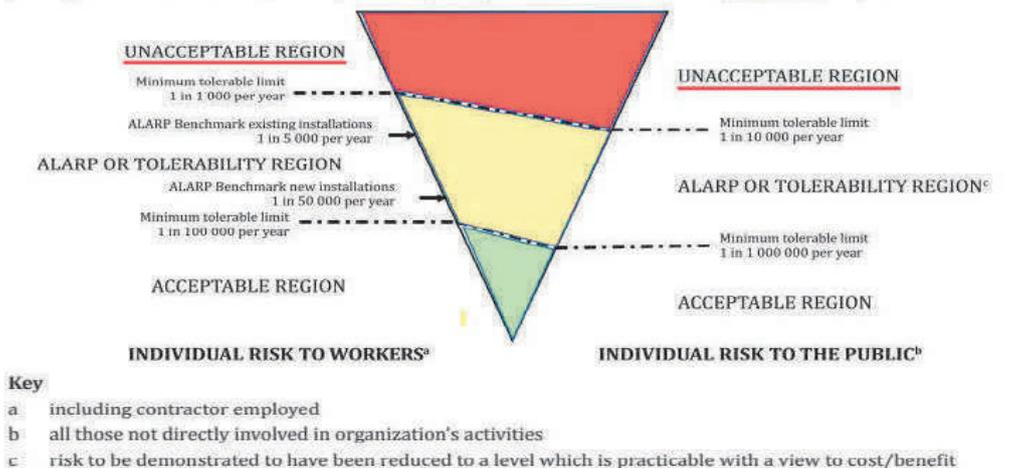
Figura 8: criteri di accettabilità del rischio da UNI EN ISO 20257
