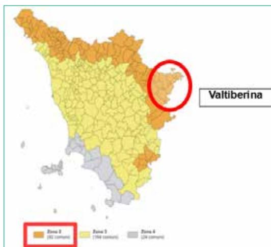
Figura 4.1 Classificazione sismica della Regione Toscana
