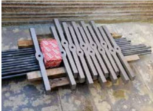
**Fig. 7.1.2.16 - Particolare dei paletti capochiave Sansepolcro (AR)** Fonte: portale sismica Portos
